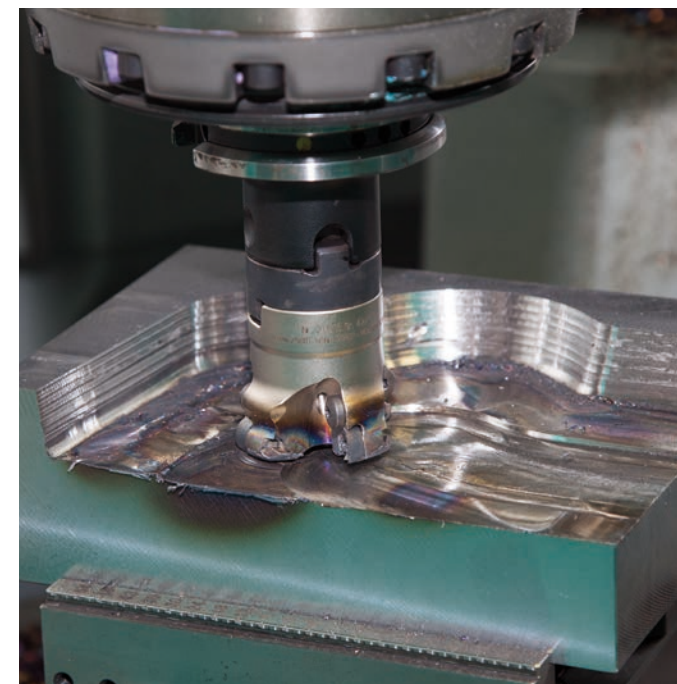
Pieza defectuosa con daños tras la rotura de las placas de corte
