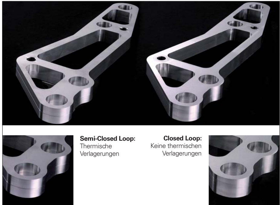
Abbildung 6 Hebelbauteil, zweifach auf einem Rohling gefertigt
