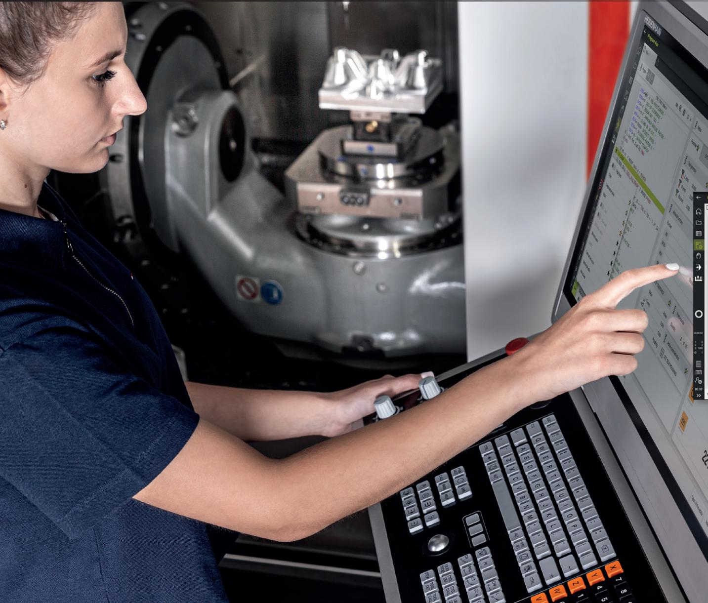
Le funzioni e i requisiti di una macchina CNC sono molteplici. Creazione del programma, attrezzaggio o misurazione del pezzo finito: TNC7 supporta in modo ottimale l'operatore in qualsiasi attività. Con un pacchetto di funzioni molto ampio, TNC7 offre massima flessibilità di lavorazione.
