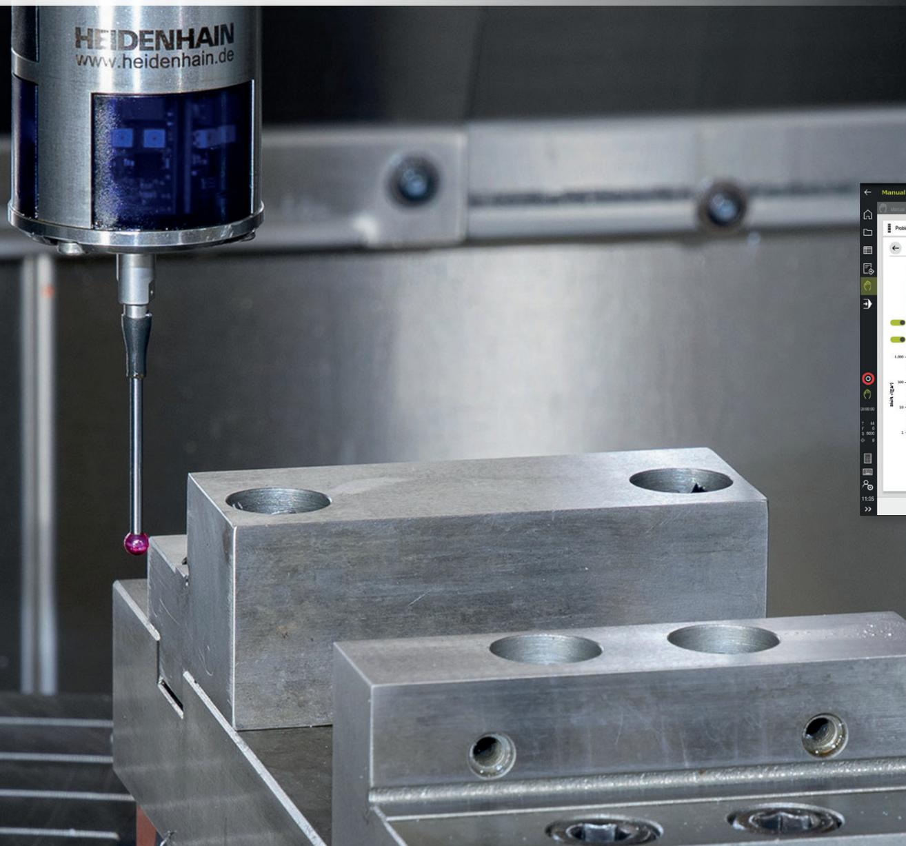
TNC7 porta l'opzione DCM (Dynamic Collision Monitoring) nella generazione successiva. DCM protegge non solo da collisioni tra componenti della macchina e utensili. Anche l'attrezzatura di serraggio può essere importata in formato 3D, monitorata e con un nuovo ciclo misurata in maniera semplice grazie al supporto grafico.
