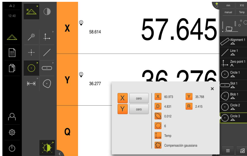
Figura 87: Elemento Círculo con Vista previa del elemento en captura de puntos de medición con herramienta de medición OED activa
