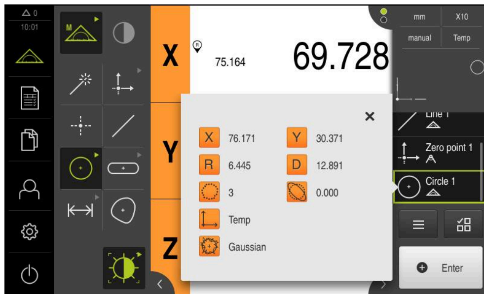
Figure 57 : Élément Cercle avec Aperçu des fonctionnalités après enregistrement des points de mesure avec l'outil de mesure OED actif.
