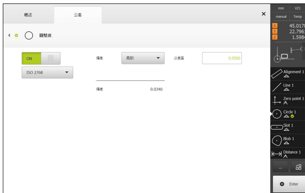
圖形 95: 形狀公差 概述 · 已啟動 圓整度公差 · 依照 ISO 2768
