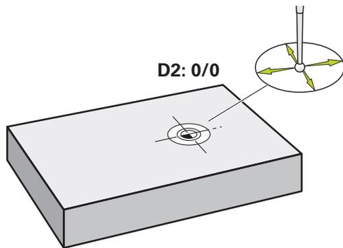
Illustration 21 : Exemple de pièce – Détermination du point d'origine D2
