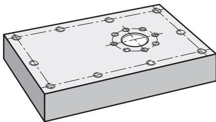
Illustration 23 : Exemple de pièce – Programmation d'un cercle de trous et d'une rangée de trous
