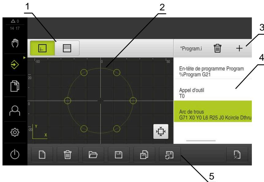
Illustration 10 : Menu **Programmation** avec fenêtre de simulation ouverte
