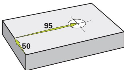
Illustration 18 : Exemple de pièce – Usinage d'un trou traversant
