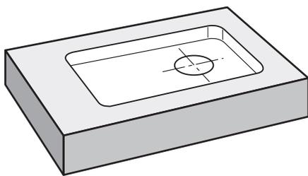
Illustration 20 : Exemple de pièce – Usinage d'un ajustement
