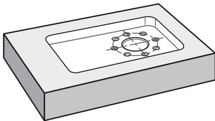
Illustration 22 : Exemple de pièces – Usinage d'un cercle de trous
