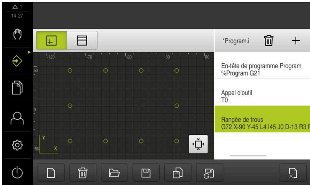
Illustration 24 : Exemple de pièce -Fenêtre de simulation
