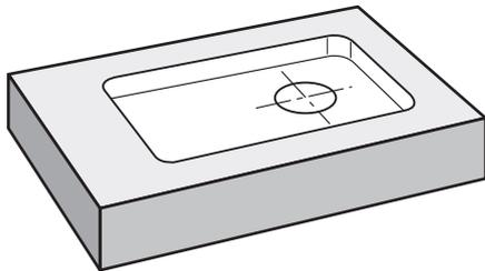
Illustration 19 : Exemple de pièce – Usinage d'une poche rectangulaire
