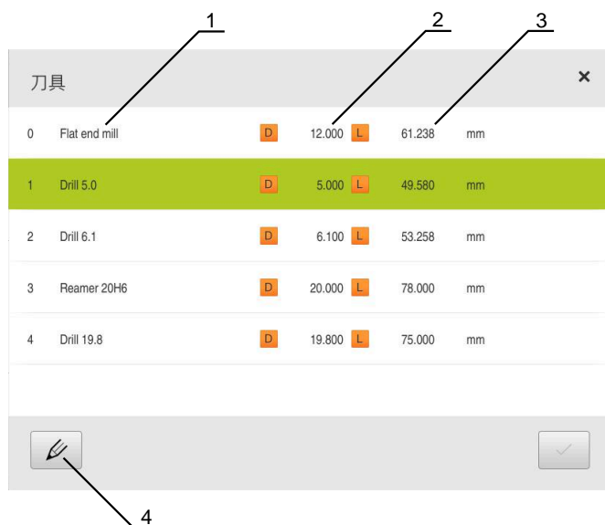
图 28: 带刀具参数的刀具表
