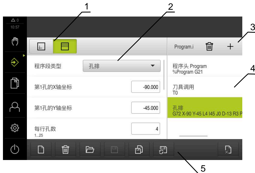
图 58: 程序编辑操作模式下的程序举例
