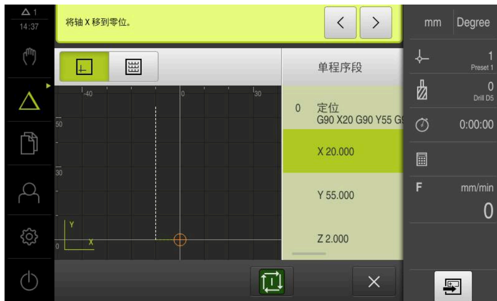
图 51: 举例 – 带缩放系数MDI程序段的执行
