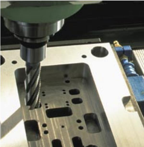
Auf diese Weise wird eine Bohrposition, welche 250 mm tief ist, nur mit dem ersten Tiefbohrwerkzeug angefahren, ein Bohrung mit 1100 mm Tiefe aber 4 mal angefahren und zwar immer dann, wenn das jeweils richtige Werkzeug gerade im Einsatz ist. Leerwege und unnötige Werkzeug-Wechsel werden vermieden.
