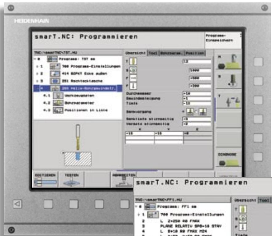
Bild 1: Bearbeitungsschritte werden in Form von UNITS angezeigt
