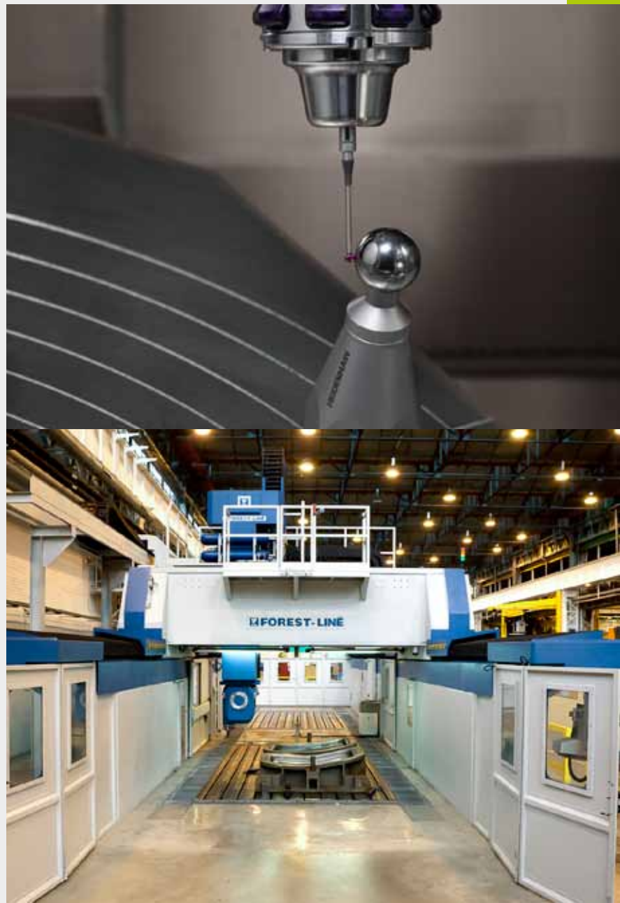
Reproduzierbare Schwenkgenauigkeit über lange Zeiträume mit KinematicsOpt.
