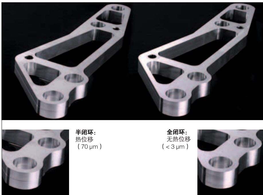
图5 连接杆，从毛坯开始加工两次
