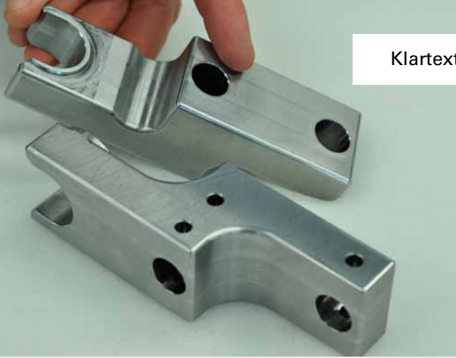
Montage-Hilfe, direkt an der Steuerung programmiert.
