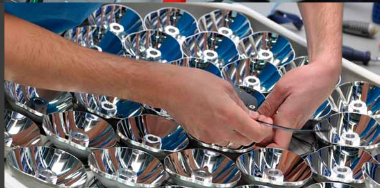
Die genaue Ausrichtung der Aufnahmen für die LED-Blöcke liefert einen wichtigen Beitrag für ein homogenes Lichtfeld
