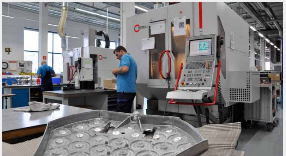
Das Gussteil wird in einer Aufspannung bearbeitet.
