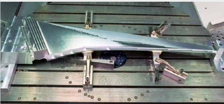
AFC regelt automatisch den Bahnvorschub in Abhängigkeit von der jeweiligen Spindelleistung und den vom Anwender definierten Grenzwerten. Auf diese Weise kann insbesondere bei Gussteilen, die naturgemäß starke Aufmaß- und Materialschwankungen aufweisen, die Bearbeitungszeit spürbar verkürzt werden. Die adaptive Vorschubregelung sorgt dafür, dass die Spindelleistung während des →
