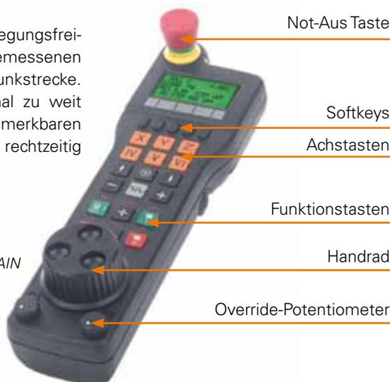
Um das Funkhandrad Ihren spezifischen Arbeitsabläufen anzupassen, verfügt es über fünf **Softkeys**. Diese können mit speziellen Funktionen belegt werden, die jeweils im Display angezeigt werden. Außerdem kann der Maschinenhersteller die sechs mit LEDs beleuchtbaren **Funktionstasten** ebenfalls mit speziellen Funktionen belegen. Die Symbole der Achsbezeichnungen und der Funktionstasten sind auswechselbar.
