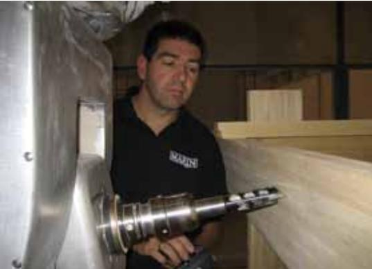
*Gert van de Pol, CAD/CAM-Techniker, konzentriert sich auf das Anfahren des Fräasers mittels Handrad ...*
